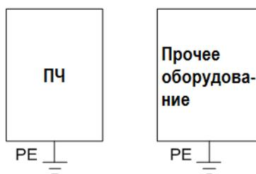
Для заземления используйте провод достаточного сечения, чтобы уменьшить сопротивление линии заземления;
