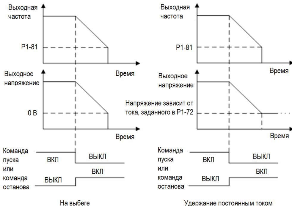
Примечание: если P1-81 > P1-84, работает функция P1-80, а функция торможения постоянным током работать не будет; если P1-81 < P1-84, функция торможения постоянным током будет работать, а функция P1-80 работать не будет.
