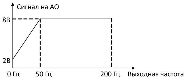
Если P3-52=80.00% (40 Гц), P3-53 = 10.00% (5 Гц), соотношение между выходной частотой и выходным сигналом на выходе АО показано ниже:
