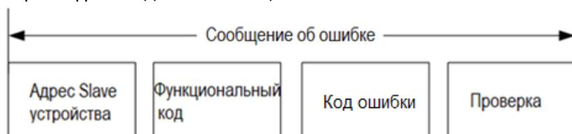
Здесь функциональный код = код функции запроса + 0x80
