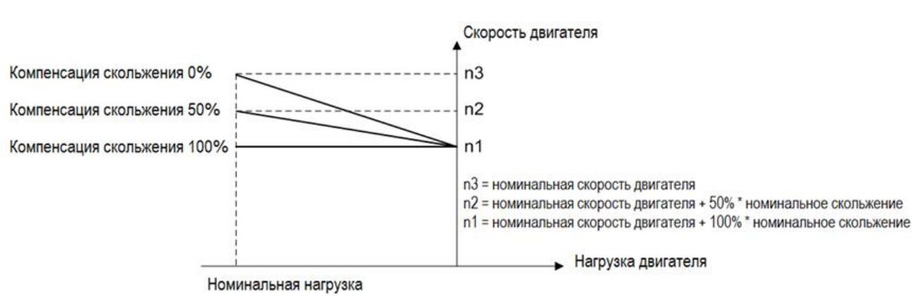
При наличии более одного двигателя на одном валу существует необходимость в распределении нагрузки между двигателями. Этого можно достичь, запустив двигатели в разомкнутом контуре скорости и установив для одного отрицательную компенсацию скольжения (контроль неравномерности).
