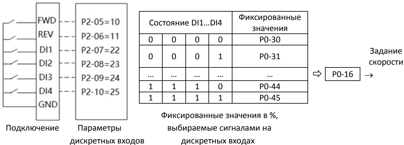
На рисунке выше входы FWD и REV настроены на двухпроводное управление, а входы DI1-DI4 – на выбор фиксированных заданий. Скорость задается в % от значения P0-16, значение в % выбирается комбинацией сигналов на входах DI1-DI4; например, если состояние входов DI1-DI4 равно 1111, то выбирается значение в %, записанное в параметре P0-45. Задание скорости равно  $P0-45 * P0-16$ . Если для выбора фиксированного задания выбрано менее 4-х входов, то состояние недостающих входов принимается равным 0.
