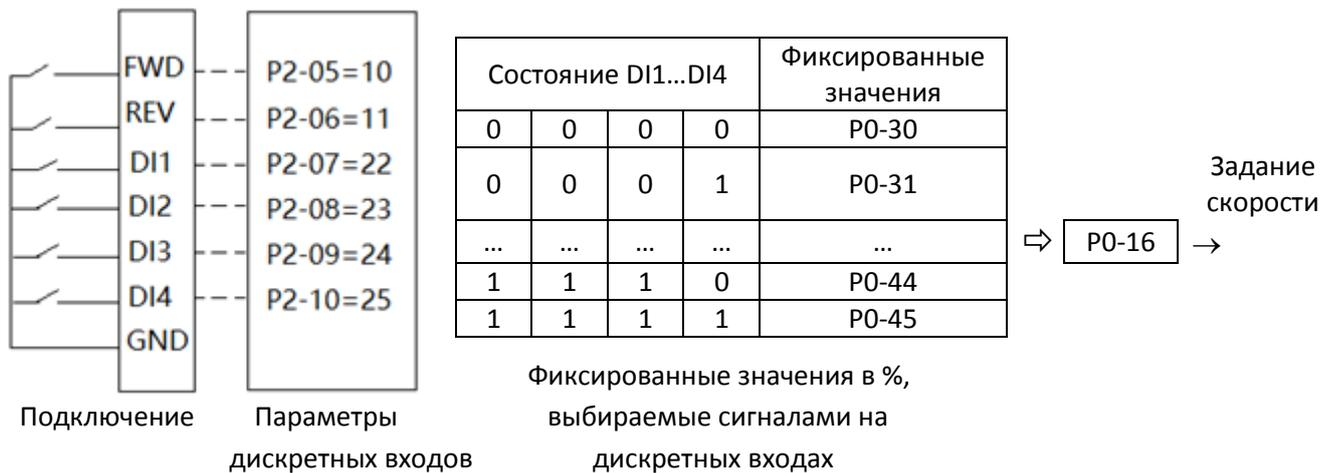
На рисунке выше входы FWD и REV настроены на двухпроводное управление, а входы DI1-DI4 – на выбор фиксированных заданий. Скорость задается в % от значения P0-16, значение в % выбирается комбинацией сигналов на входах DI1-DI4; например, если состояние входов DI1-DI4 равно 1111, то выбирается значение в %, записанное в параметре P0-45. Задание скорости равно P0-45 \* P0-16. Если для выбора фиксированного задания выбрано менее 4-х входов, то состояние недостающих входов принимается равным 0.
