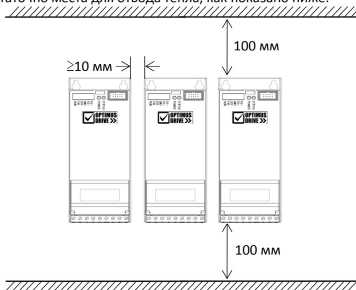
Если указанное расстояние между преобразователями обеспечить нельзя, то следует уменьшить ограничение температуры окружающего воздуха.
