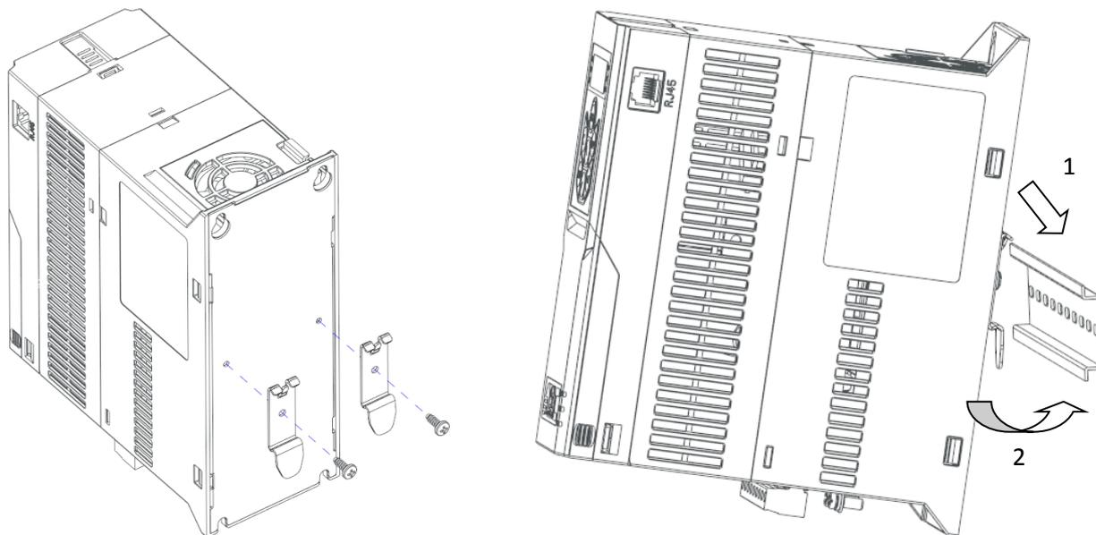
Шаг 1: Установите скобы крепления на корпус ПЧ с помощью винтов
