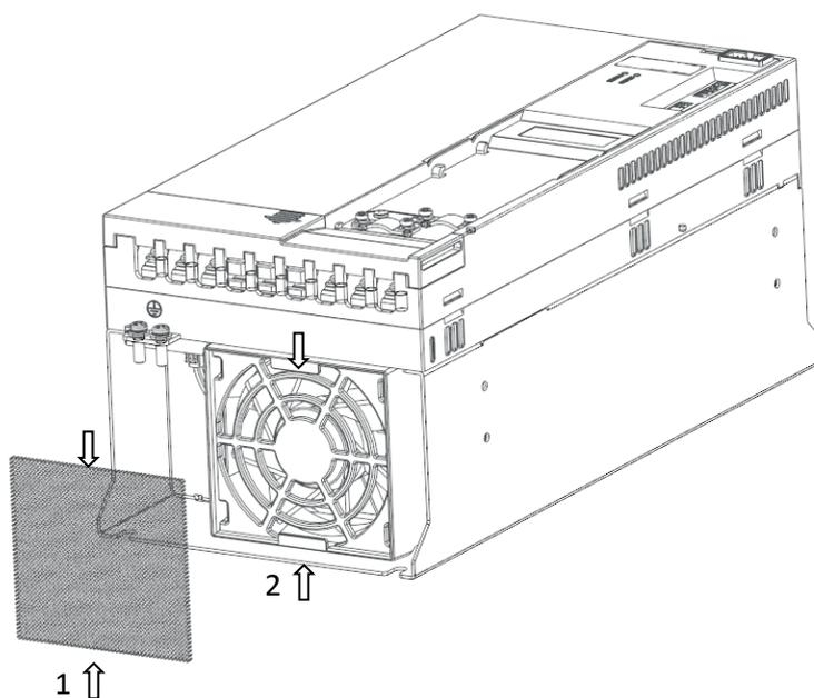
Слегка сожмите фильтр сверху-снизу и вставьте его в опорную часть вентилятора
