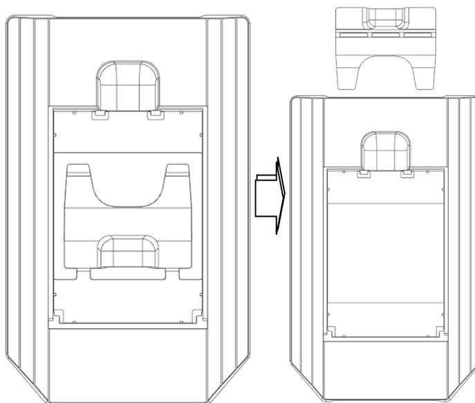
Шаг 2: Подготовка: снимите фиксатор
