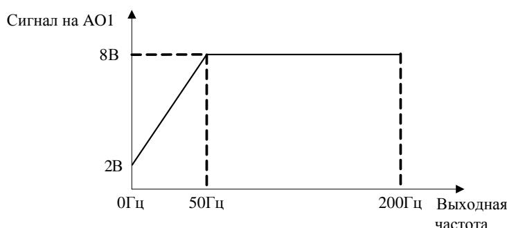
Если Р3-52=80.00% (40 Гц), Р3-53 = 10.00% (5 Гц), соотношение между выходной частотой и выходным сигналом на выходе АО1 показано ниже:
