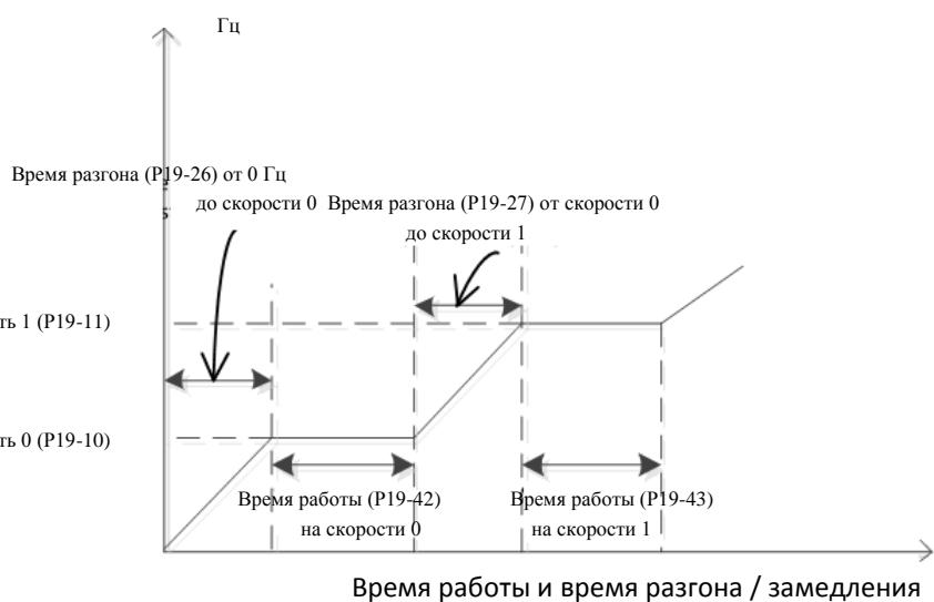
Внимание: Если времена разгона/замедления и времена работы на шаге X равны 0, то все следующие шаги игнорируются. Например, если P19-29 (время разгона/замедления на шаге 3) и P19-45 (время работы на шаге 3) равны 0, то шаги с 3 по 15 игнорируются.
