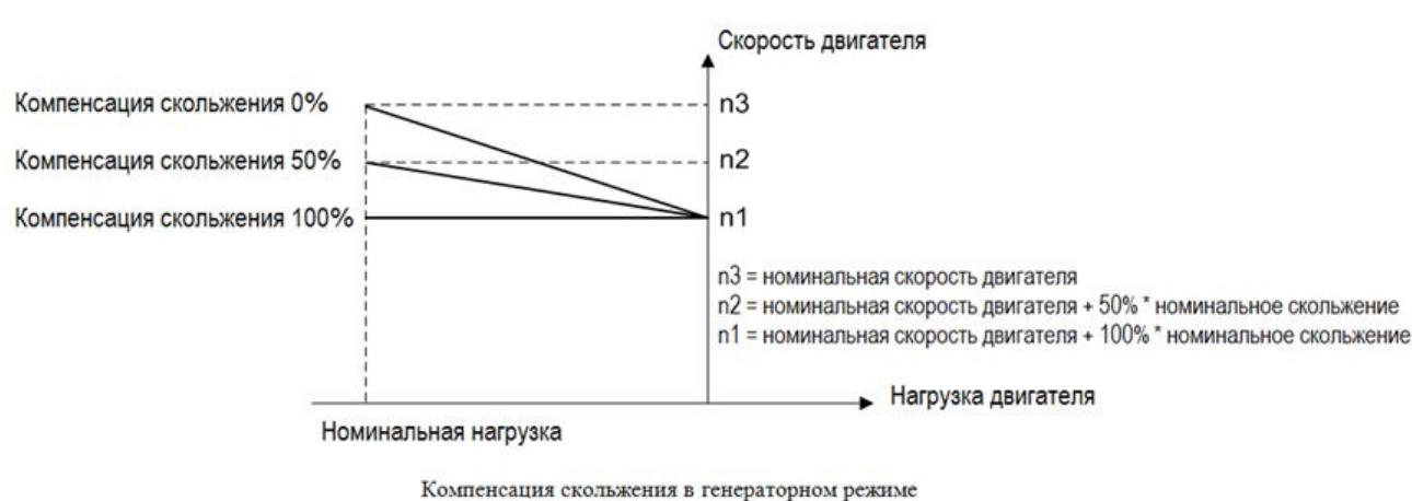
При наличии более одного двигателя на одном валу существует необходимость в распределении нагрузки между двигателями. Этого можно достичь, запустив двигатели в разомкнутом контуре скорости и установив для одного отрицательную компенсацию скольжения (контроль неравномерности).
