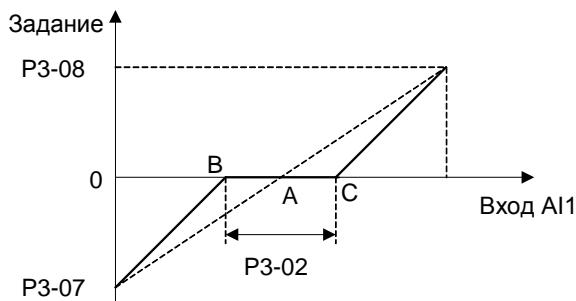
Точка A, показанная на рисунке, является аналоговым значением, которое соответствует заданному нулевому значению. Она рассчитывается с помощью аналоговых нижнего и верхнего опорных значений. После установки на AI1 зоны нулевого сигнала,  $U_{AB} = U_{AC} = P3-02 / 2$ . Если сигнал на входе AI1 находится между B и C, задание для входа AI1 равно 0.
