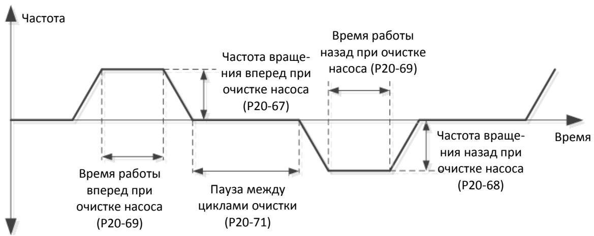
Для сигнала очистки насоса можно использовать любой дискретный вход, кроме FWD; этому входу необходимо назначить функцию 65: *Очистка насоса*. По окончании процедуры очистки ее можно повторить, отключив и вновь подав сигнал на этот вход. Функция очистки насоса не работает при P20-73 *Режим работы каскада насосов = 1: С постоянным ведущим* или при P20-40 *Работа в каскадном режиме по сети = 1: Включена*. Время разгона определяется параметром P0-60, время замедления – P0-61.
