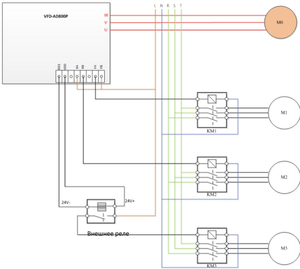
Преобразователь управляет ведущим насосом (M0), остальные насосы подключаются к сети при помощи контакторов, управляемых преобразователем.
