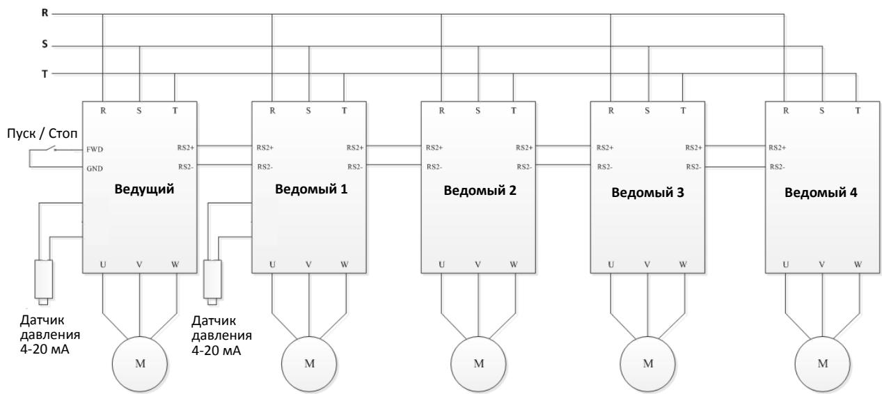
Примечание: при использовании резервного ведущего необходимо соединить его клеммы FWD и GND с такими же клеммами на основном ведущем.
