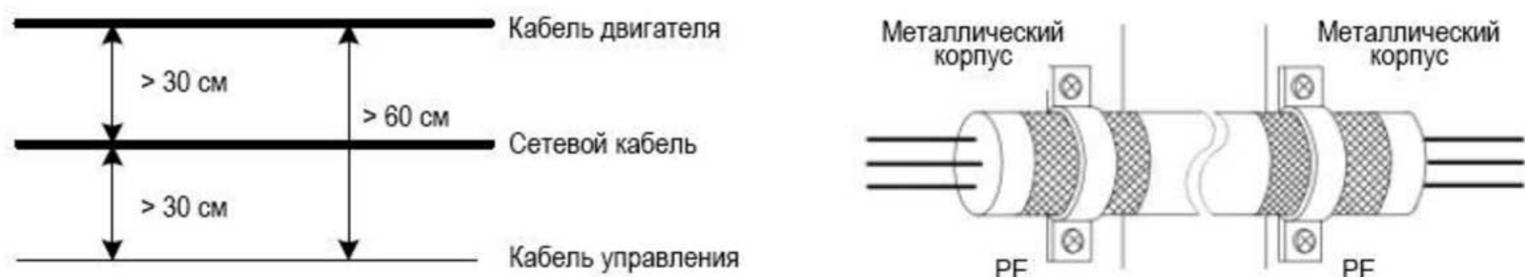
Рис. 8-1 Прокладка кабеля и заземление экранирования
