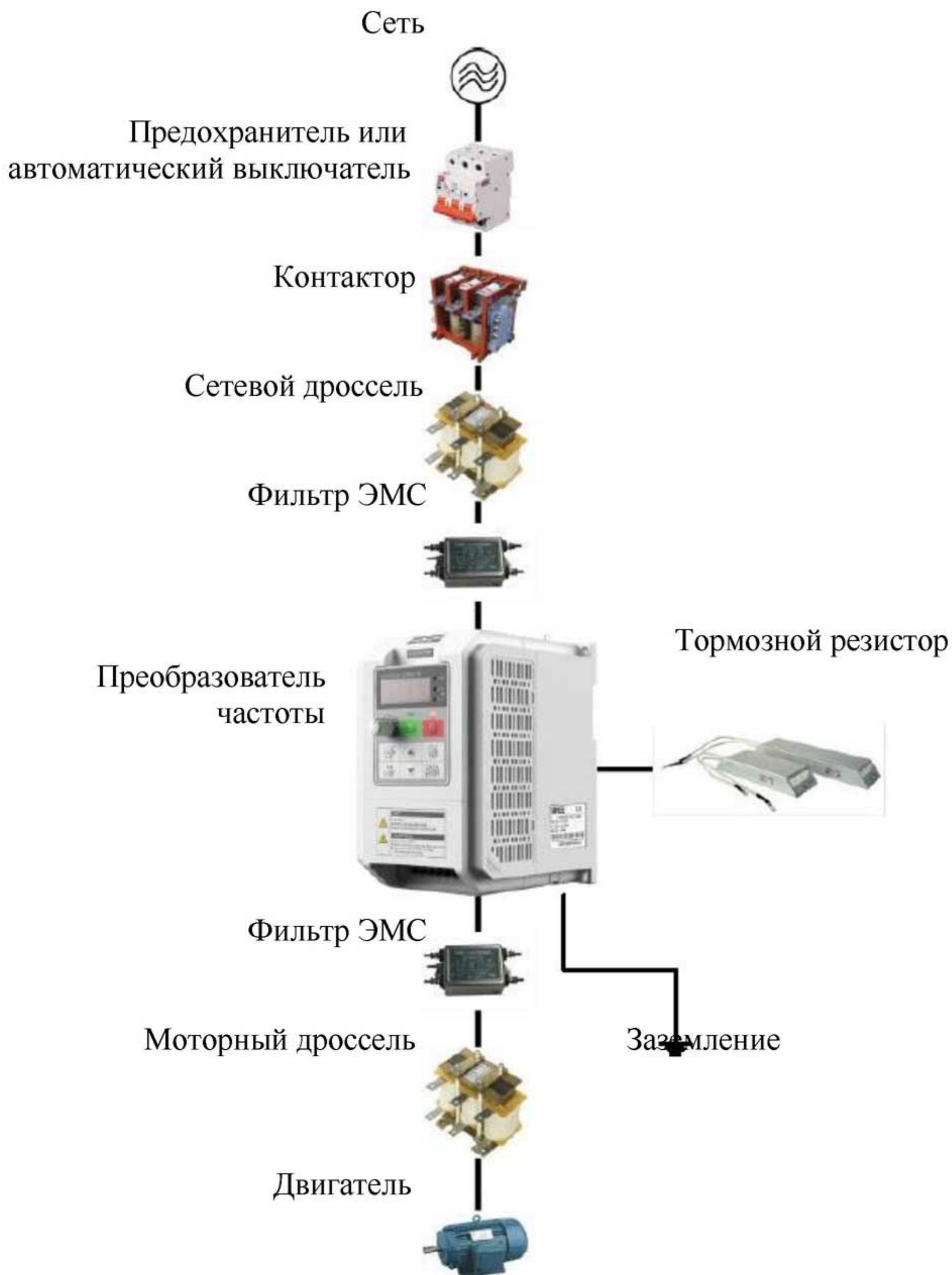
Рис. 3-1 Подключение периферийных устройств к ПЧ
