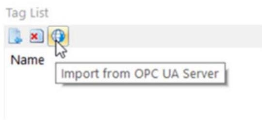
При наличии нормального соединения ПК – контроллер, среда разработки DIAScreen найдёт в сети контроллер и выведет древо сервера (контроллер MX308):
