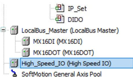
Щёлкните на пункте High Speed IO дважды левой кнопкой мышки, откроется вкладка параметров входов-выходов на ЦПУ. Выберите в ней пункт Internal I/O Mapping, в которой будут видны физические адреса входов и выходов. Здесь же можно задать тэги для них. Для этого разверните список и щёлкните правой кнопкой мышки на самом верхнем входе. В открывшемся окне выберите пункт Create I/O variables и, например, Name by Prefix.
