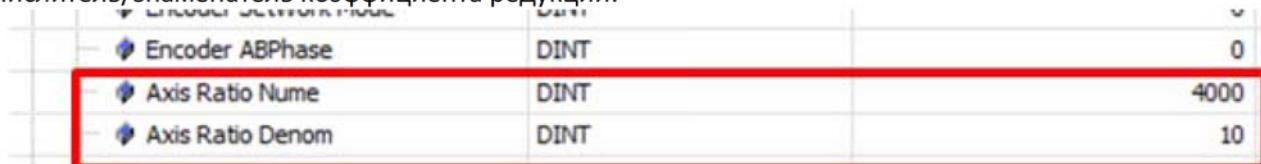
Так как у контроллера максимальная частота выхода 200 кГц, то максимальное число импульсов на оборот в настройках сервопривода будет 4000 импульсов на оборот. Данное значение заносится в пункт **Axis Ratio Nume**. В пункт **Axis Ratio Denom** заносится перемещение на 1 оборот в единицах пользователя. На рисунке выше стоит 10 ед.. Это означает, что если в командах движения будет задана позиция 10, то контроллер выдаст 4000 импульсов, т.е. привод сделает 1 оборот.
