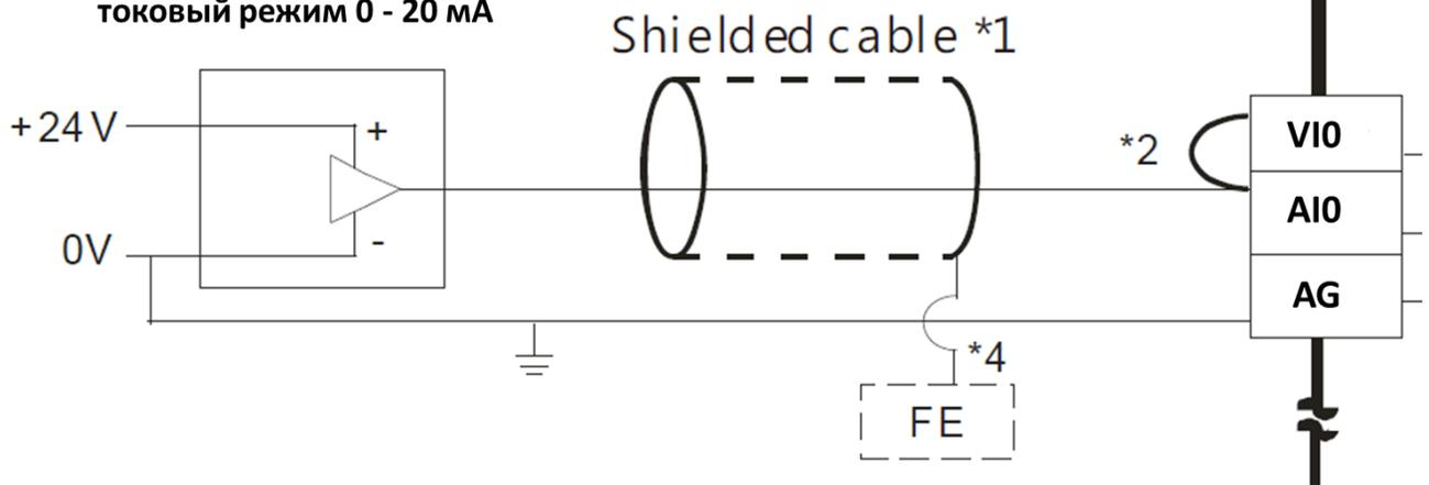
Если датчик имеет обе клеммы питания и два отдельных выхода сигнала:
