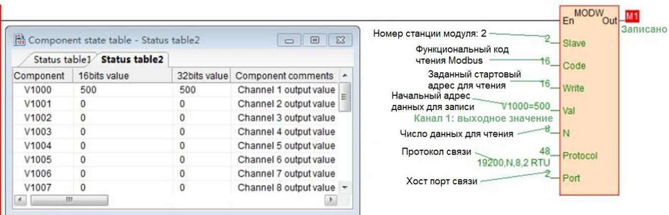
ЦПУ записывает 8-канальные аналоговые выходные значения от S08AO с помощью инструкции записи Modbus MODW, начальный адрес — 10H (шестнадцатеричный формат), десятичное значение — 16. При успешной записи M1 включен, состояние 8 выходных значений каналов удаленного модуля аналоговых входов/выходов соответствуют V1000-1007 в программе.
