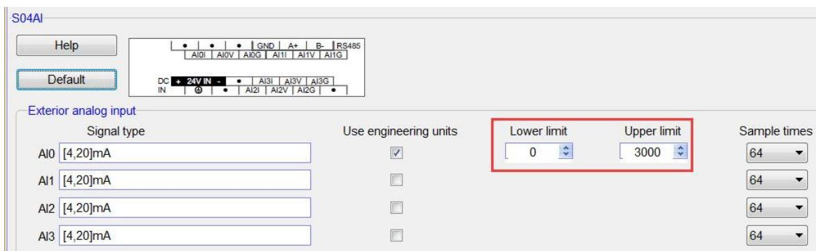
Аналогично, для аналогового выхода установим нижнее предельное значение 0, соответствующее 0,0 Гц, верхнее предельное значение 500, соответствующее 50,0 Гц и, если необходимо, чтобы выходная частота ПЧ составляла 25,6 Гц, принудительно установим значение AQ0 как 256, чтобы вывести значение AQ0, равное 256. Как показано ниже:
