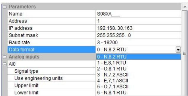
В настройках внешнего аналогового входа можно установить тип сигнала каждого канала, выбрать, использовать ли инженерное значение или нет, верхний и нижний пределы инженерного значения (его можно установить, если вы проверите необходимость использования инженерного значения), частоту дискретизации и коррекцию нуля.
