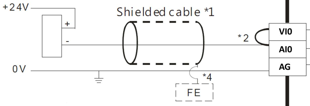
Если датчик имеет одну плюсовую клемму питания, плюсовой выход сигнала и общий минус для питания и сигнала:
