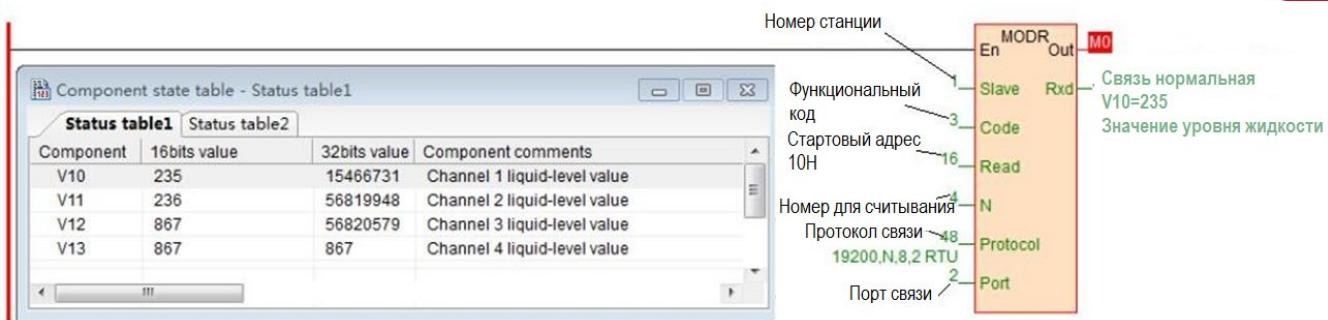
ПЛК верхнего уровня считывает 4-канальные значения уровня жидкости S04AI с помощью инструкции чтения Modbus MODR, начальный адрес — 10H (шестнадцатеричный формат), то есть десятичное значение — 16. Когда связь прошла нормально, M0 включен, значения уровня жидкости, которыечитываются, будут сохранены в V0-3, V0=235 указывает, что фактический уровень для первого канала составляет 0,235 м, V3=867 что указывает, что фактический уровень для четвертого канала составляет 0,867 м.
