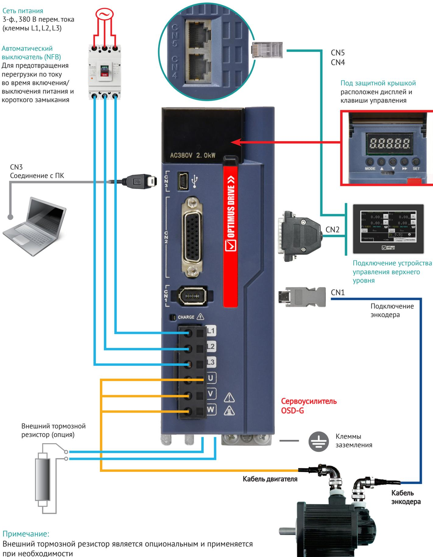
Под защитной крышкой расположен дисплей и клавиши управления
