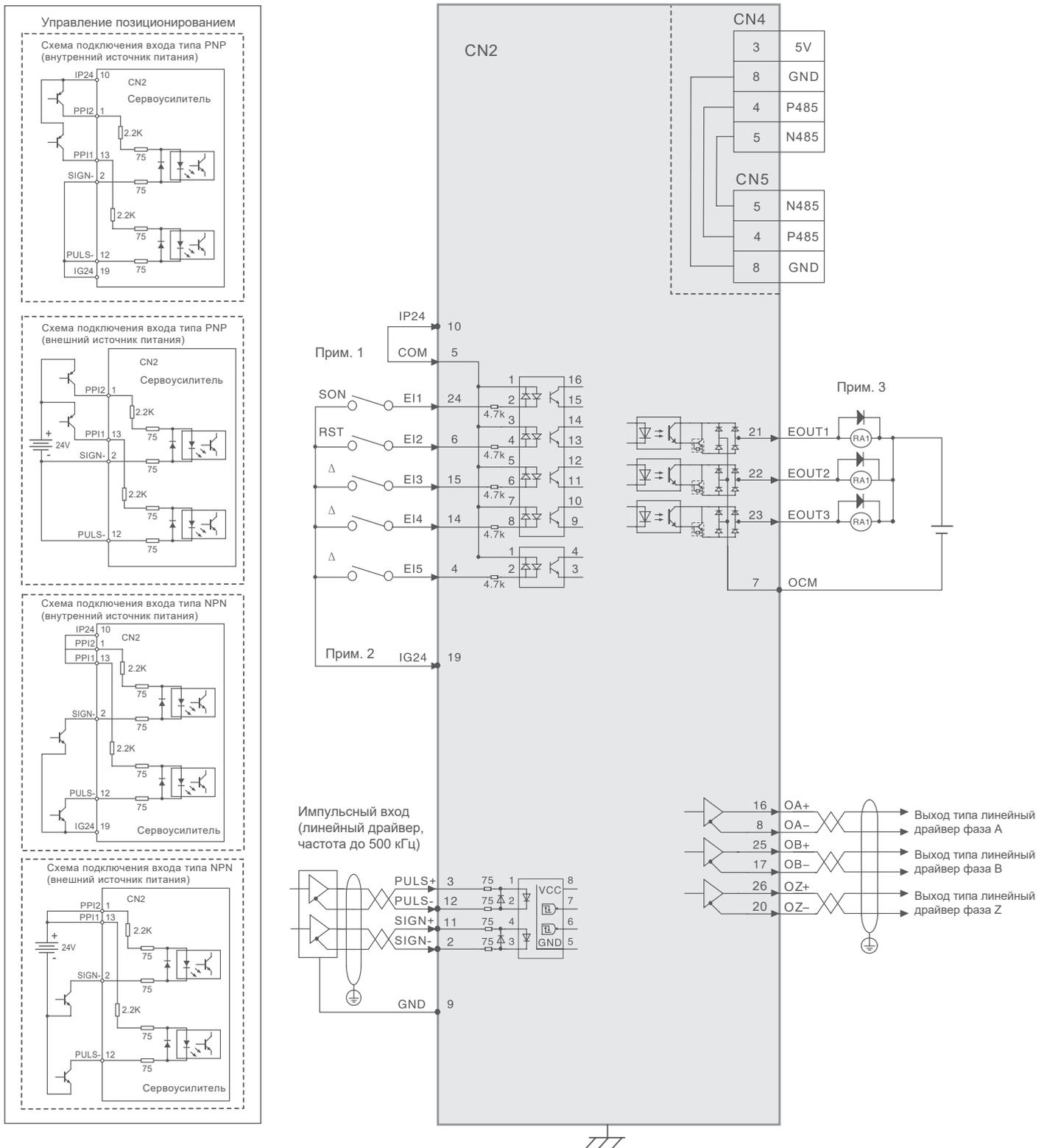
**Примечание 1:** Когда используется внешний источник питания, снимите перемычку COM - IP24, внешний источник питания 24 В подключается к COM.
