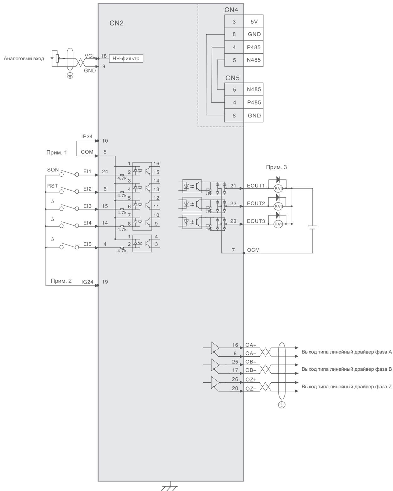
**Примечание 1:** Когда используется внешний источник питания, снимите перемычку COM - IP24, внешний источник питания 24 В подключается к COM.
