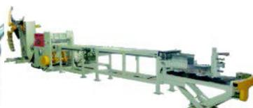
Оборудование для резки рулонного металла
