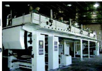
Оборудование для нанесения покрытия
