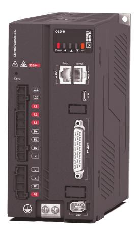
Сервопривод серии OSD- Н представляют собой высокопроизводительные комплекты серводвигателей и сервоусилителей, предназначенные для высокоточного управления по положению, по скорости и по крутящему моменту с номинальной мощностью до 2 кВт, для моделей с питающим напряжением 220В, и до 22 кВт для моделей с питающим напряжением 400 В. Системы обеспечивают, оптимальное решение для различных применений и достаточно просты в настройке.
