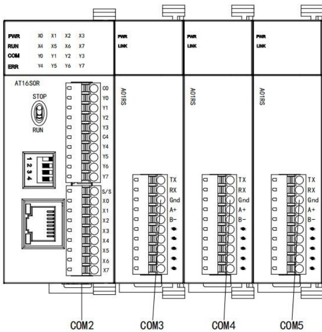
При расширении системы коммуникационными модулями ближайшим к ЦПУ ПЛК коммуникационным портом будет COM3, следующим будет COM4, последним будет COM5. Положение коммуникационного модуля может быть произвольным, а номер коммуникационного порта можно просмотреть в аппаратной конфигурации, как показано на рисунке ниже:
