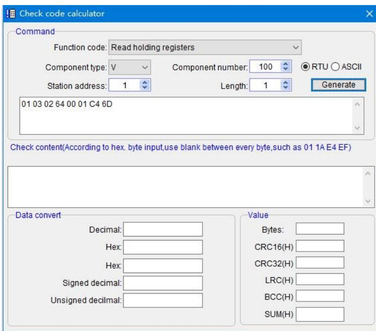
В поле окна выбираются функциональный код, тип компонентов, номер компонента, номер станции ведомого ПЛК и т.д., затем нажимаем «Создать (Generate)», получается команда: 01 03 02 64 00 01 C4 6D, отправленная компьютером верхнего уровня. позволяет прочитать значение V100 ПЛК.
