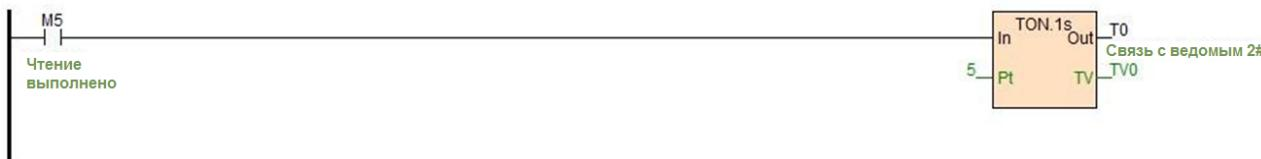
Время для определения отключения связи может быть установлено в соответствии с фактическим, как указано выше, когда М5 отключен более 5 секунд, катушка Т0 будет выдавать сигнал тревоги об отключении связи.
