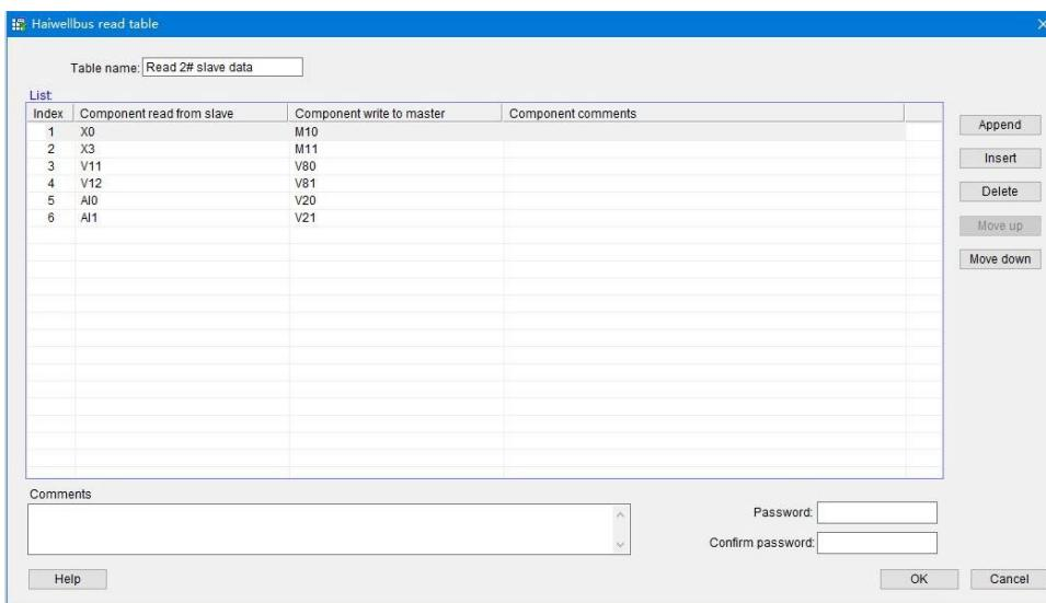
В ПО для программирования ПЛК настройте коммуникационную таблицу Speedbus для записи следующим образом:
