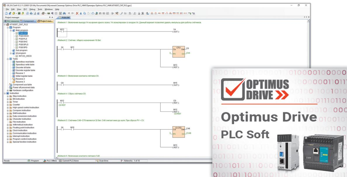
Единая функциональная среда программирования Optimus Drive PLC Soft для всех контроллеров линеек C/T/H и AC/AT/AH. Поддерживает три языка стандарта МЭК 61131-3-2016 (LD, FBD и IL), удобна в использовании и проста в освоении.
