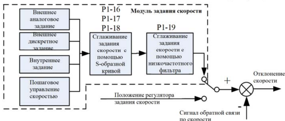
Рис.7-7 Схема передачи команды задания скорости
