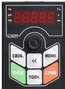
Встроенный в модуль управления CU04 съемный пульт может использоваться для установки/считывания параметров, управления, мониторинга и т. д.
