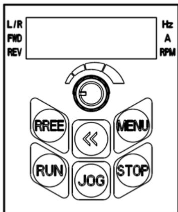
Встроенный в модуль управления CU0B пульт может использоваться для установки/считывания параметров, управления, мониторинга и т. д.
