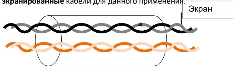
Для аналоговых сигналов необходимо использовать изолированный экранированный кабель, а кабели для дискретных сигналов экранированную витую пару. Кабели для разъемов CN1 должны быть диаметром 24-28AWG.
