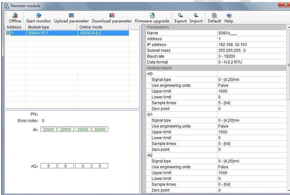
При необходимости, можно изменить имя модуля, адрес, IP, маску подсети, скорость передачи данных, формат данных и другие параметры связи в области параметров связи.
