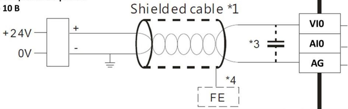
Если датчик имеет одну плюсовую клемму питания, плюсовой выход сигнала и общий минус для питания и сигнала:
