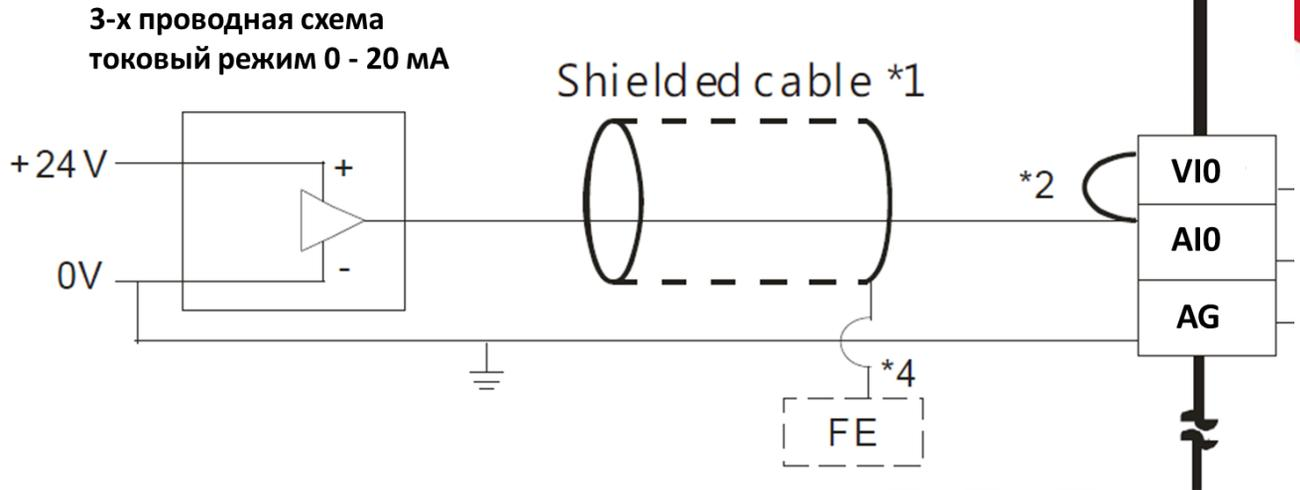
Если датчик имеет обе клеммы питания и два отдельных выхода сигнала:
