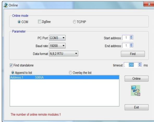
Если к линии RS485 подключен только один объект, то отметьте «Stand-alone search (автономный поиск)»; если их несколько, то отключите кнопку "Stand-alone search" и установите начальный адрес и конечный адрес, чтобы можно было найти все объекты, подключенные к линии RS485, и выполнить настройку параметров.
