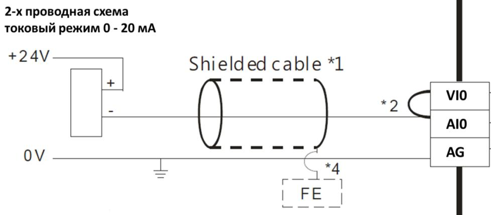
Если датчик имеет одну плюсовую клемму питания, плюсовой выход сигнала и общий минус для питания и сигнала:
