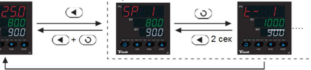
Пример настройки сегмента программы: Формат температура-время-температура единообразно используется в создании программы, которая определяется как установка температуры из текущего сегмента и достижение следующей температуры по истечении времени, установленного в этом сегменте.
