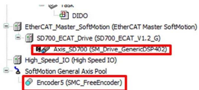
Как правило, штурвальные энкодеры имеют 100 импульсов на оборот. Для корректного подсчёта импульсов счётчик должен быть настроен на режим 4AB, т.е. будет приниматься 400 импульсов на 1 оборот энкодера.
