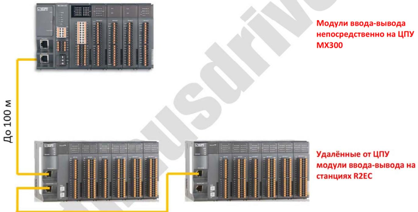
Рассмотрим порядок работы с удалёнными станциями. Сначала создайте проект и добавьте в него устройство типа ЦПУ MX300 и адаптер EtherCAT, как описано в соответствующих Разделах данного Руководства.
