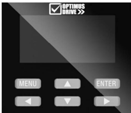
В данной Главе рассматривается работа через встроенный дисплей. Дисплей автоматически гаснет через 10 мин при отсутствии нажатий на кнопки.
