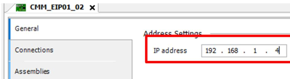
Далее в пункте **Connections** можно увидеть разметку данных от Ведомого (CMM-EIP01/02) и к Ведомому от Мастера (MX308), которая будет сделана системой в соответствие с EDS файлом на плату CMM-EIP01/02:
