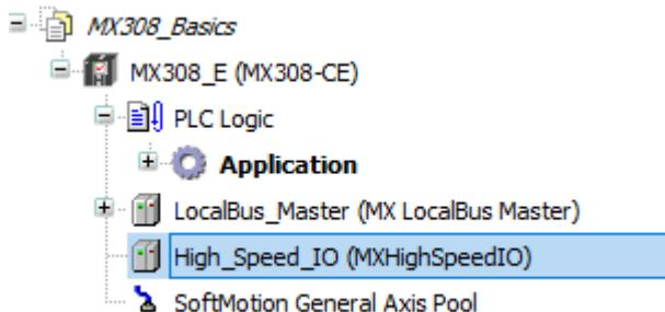
Создайте счётчик **Counter0** (см. Работа с высокоскоростными счётчиками, стр. 132 настоящего Руководства). Откройте вкладку **MXHighSpeedIO – High Speed Input Setting – Counter0**. Поставьте флажок **Enable** и в пункте **Probe0** выберите нужный вход на контроллере. В картинке ниже выбран вход I07.
