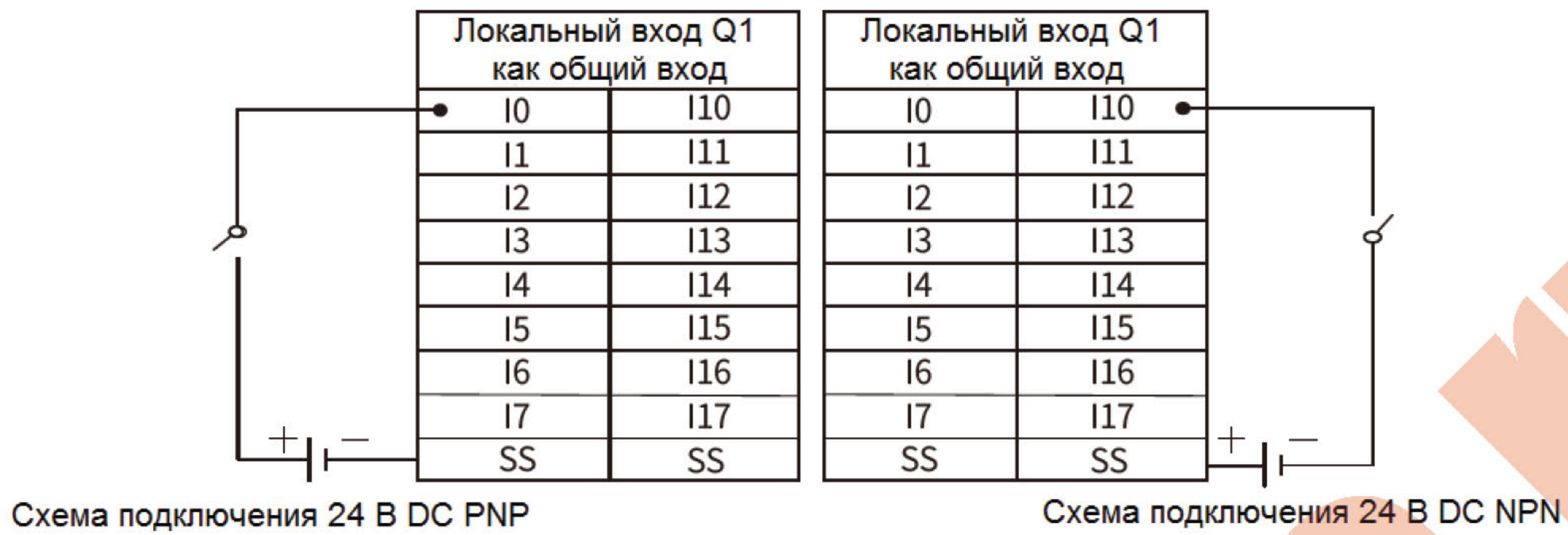
Рис. 14 Схема внешних подключений обычных входов
