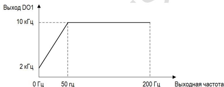
Если P2-63 = 80,00% (40 Гц), P2-64 = 10,00% (5 Гц), то зависимость между выходной частотой и частотой импульсов на выходе DO1 показана ниже:
