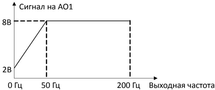
Если P3-52=80.00% (40 Гц), P3-53 = 10.00% (5 Гц), соотношение между выходной частотой и выходным сигналом на выходе АО1 показано ниже:
