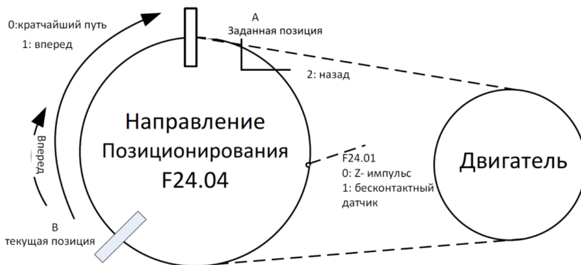
Схема направления движения при позиционировании шпинделя
