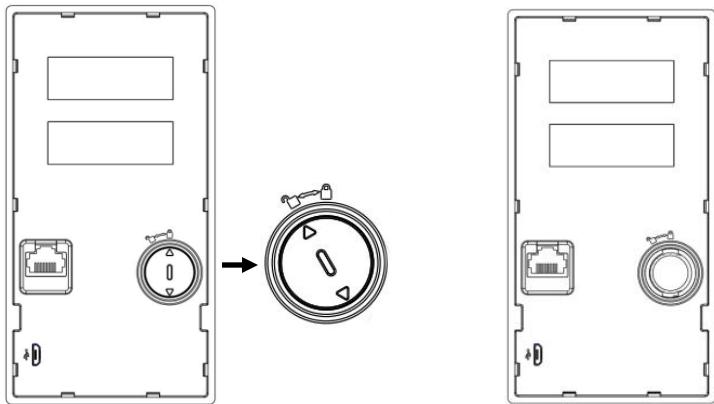
Шаг 1: Снимите крышку (поворните ее против часовой стрелки)
