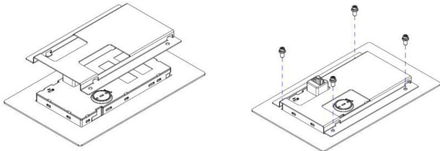
**Шаг 3:** Совместите пазы крепления кронштейна с выемками на задней стороне пульта, нажмите на кронштейн и сдвиньте его вниз в положение фиксации.
